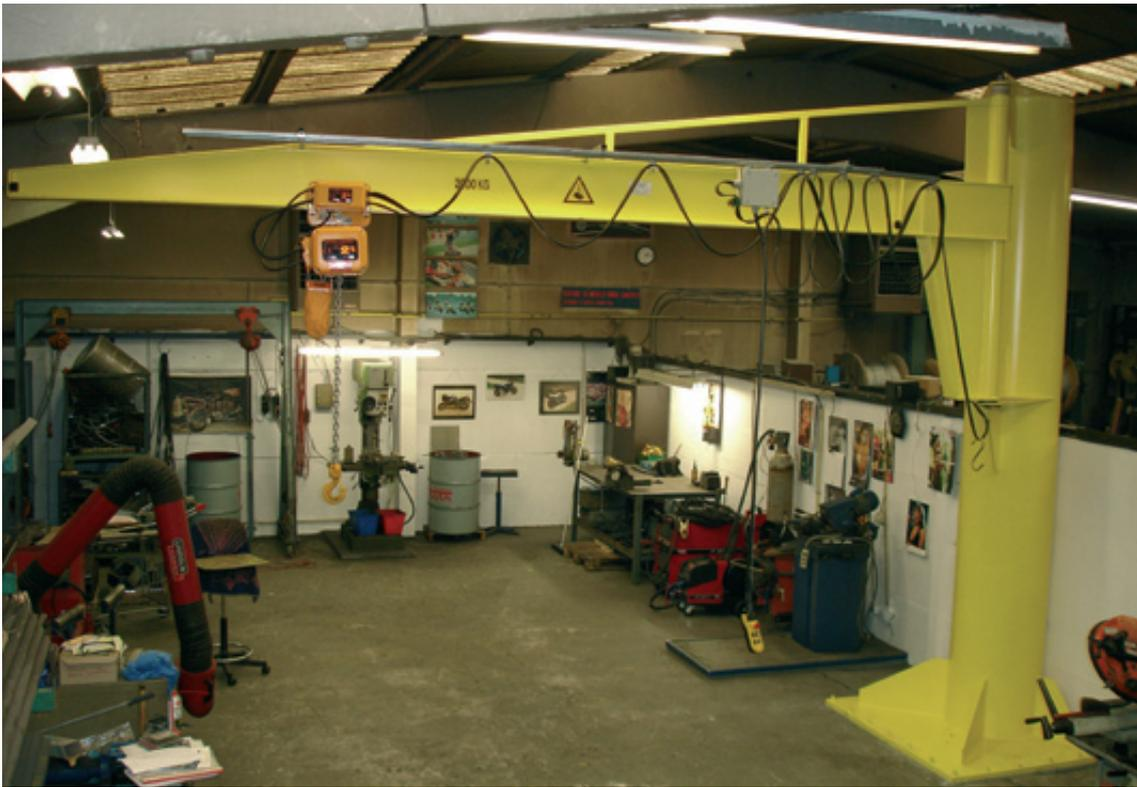
Potence à colonne équipée d'un palan avec chariot électrique KITO Type ERM020LDSDD.
