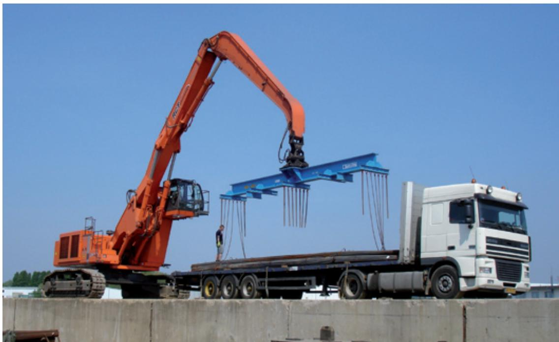
Palonniers fabriqués en nos ateliers - autres capacités et longueurs sur demande. (coefficient d'utilisation 4)
