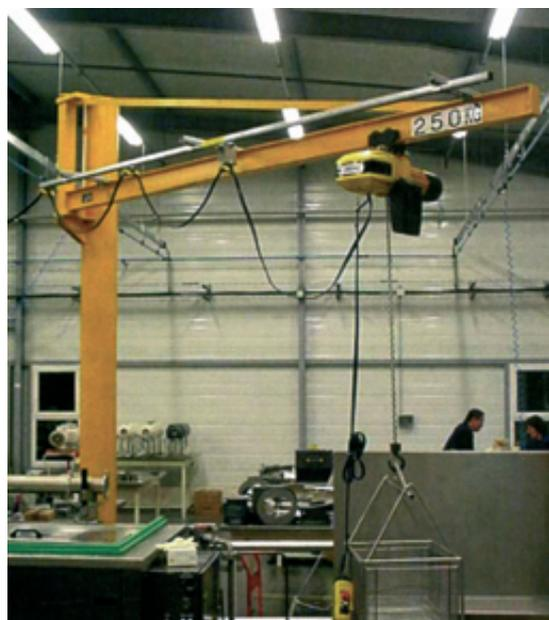
Exemple d'un palan KITO ERM avec commande à distance et boîtier de commande avec câble de réserve.
