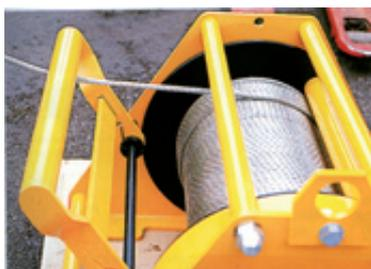
Ce dispositif arrête automatiquement le treuil lorsque le câble n'est plus tendu.
