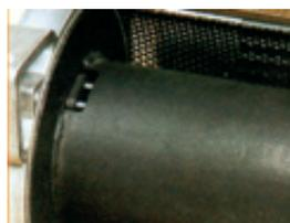
Tambour protégé par une tôle orientable perforée. Larges flasques pour 60 m de câble Ø 5mm.
