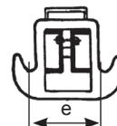
Crochet articulé sur une manille ou crochet pivotant sur demande (avec linguet de sécurité).
