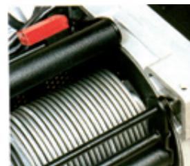
C'est le complément indispensable du tambour rainuré, dans le cas où le câble n'est pas tendu en permanence (enroulement à vide en traction).
