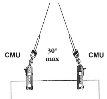
Fonction de levage de charges en position verticale à l'aide de 2 pincers sans palonnier
