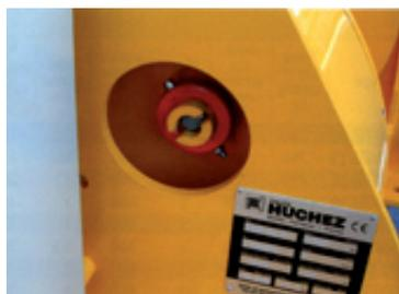
Pour dévider le câble à la main, le débrayage mécanique du tambour suffit.
