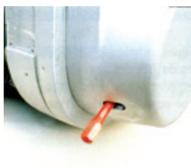
Un volant de dépannage, couplé à une manette de déblocage du frein, permet, sans courant, de descendre ou positionner une charge.
