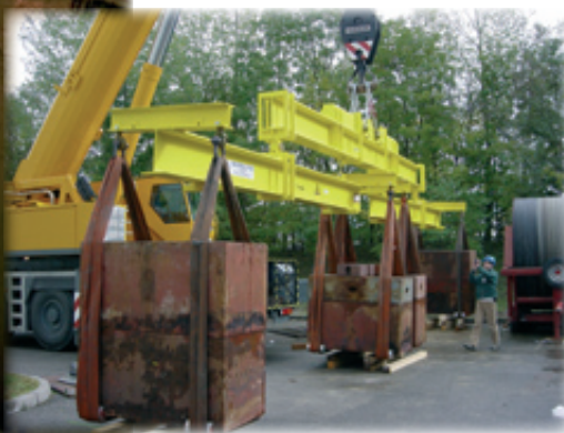
Overbelastingstest op 52 ton (150 %) (CERN, Genève 2005)
