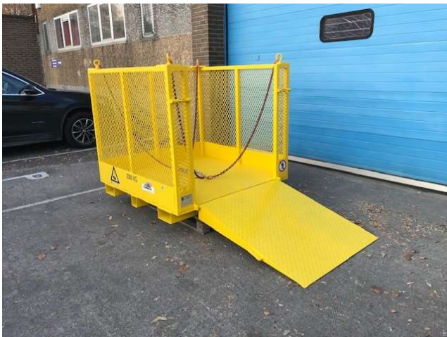
Nacelle pour le transport de matériel avec rampe d'accès
