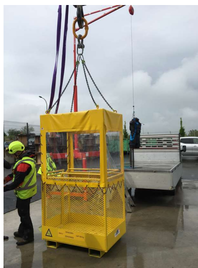
Nacelle de travail avec bâche
