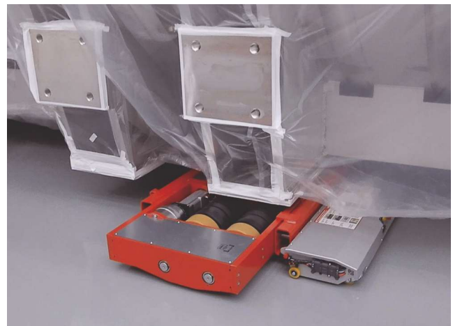
Chariot transporteur directionnel électrique JLA-e cleanroom
