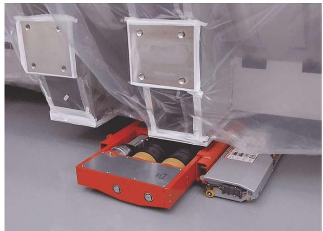
**Chariot transporteur directionnel électrique JLA-e cleanroom**
