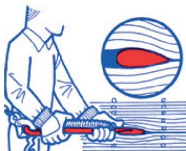
Nouveau profil pénétrant permettant de séparer 2 treillis afin d'y introduire plus facilement le crochet.
