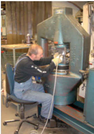
Persing van de kabellengen in onze atelier
