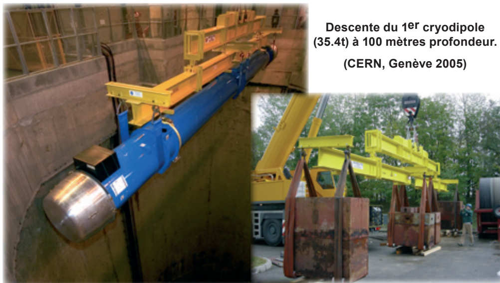
Essais en surcharge à 52 tonnes (150%). (CERN, Genève 2005)
